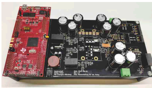
Platine des Messaufbaus zur Charakterisierung von induktiven Komponenten
