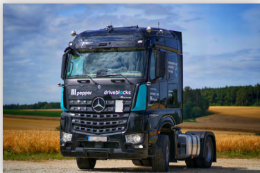
In Kooperation mit der pepper motion GmbH entwickelter Erprobungs-LKW für vollautonomes Fahren
